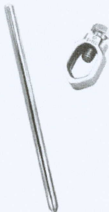
HASTE DE ATERRAMENTO EM AÇO COM 3,00 M DE COMPRIMENTO E DN = 1", REVESTIDA COM BAIXA CAMADA DE COBRE, COM CONECTOR TIPO GRAMPO
